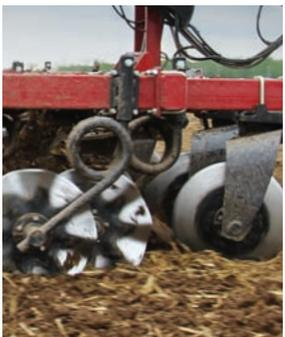
**Lames en acier au bore:** Lames en acier au bore de haute qualité pour assurer la durabilité et la longévité.
