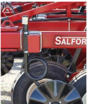
**Châssis entièrement tubulaire + embouts soudés:** Châssis tubulaire en acier de 4 po x 6 po avec embouts scellés par soudure pour maximiser la durabilité et la longévité.
