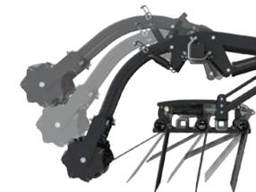
**FlexFinish :** Les systèmes de finition FlexFinish à réglage hydraulique peuvent être ajustés depuis la cabine du tracteur pour changer les options de finition lors de vos déplacements.
