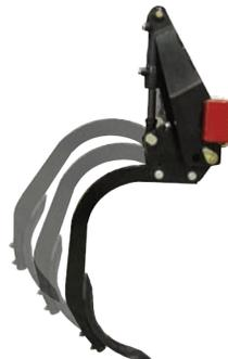
**Ensembles pattes chisel SwitchBlade :** Ajoutez les pattes SwitchBlade à engagement hydraulique aux modèles I-2100 et I-2200 pour le labourage au chisel ou pour une application anhydre ou aux modèles I-4100 et I-4200 pour une application anhydre.
