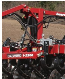
**Châssis à nivelage automatique hydraulique:** Maintient le niveau du châssis de l'avant vers l'arrière lorsque l'opérateur change de profondeur, ou élève ou abaisse la machine.
