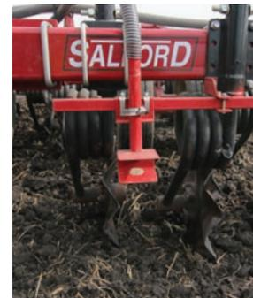
**Application en bande et à la volée :** Déposer et incorporer des petites graines ou de l'engrais sec en un seul passage. Les coutres effectuent un binage de la terre afin d'y incorporer le produit, puis la herse roulante raffermit délicatement le sol pour assurer le bon positionnement.
