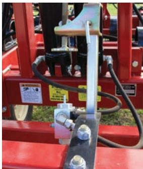
**Commande unique pour régler la profondeur:** Facilite le réglage de la profondeur de travail pour s'adapter aux conditions variables du terrain, ou pour passer d'un travail de printemps à un travail d'automne.
