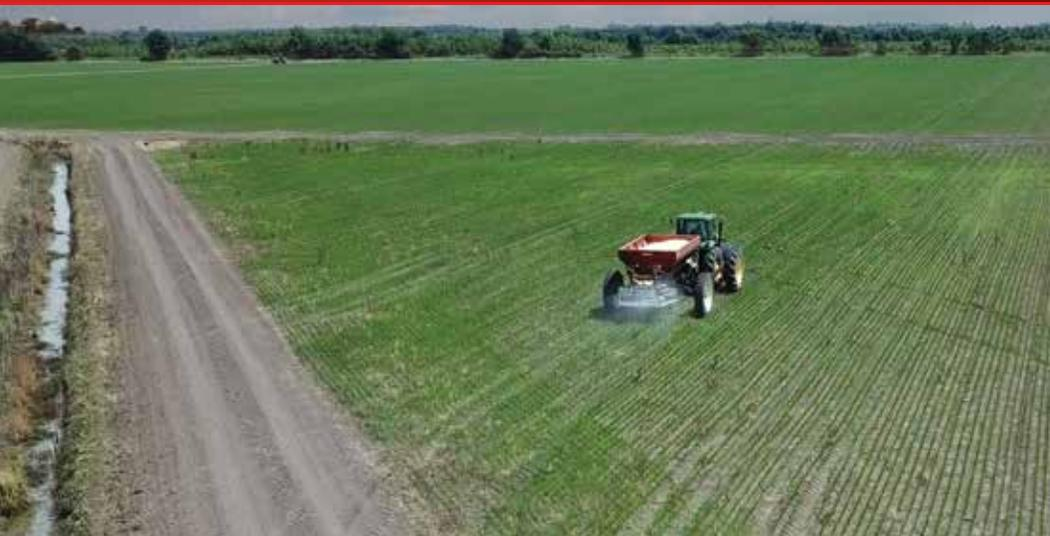
**Idéal pour :** Application d'engrais sec de 120 pieds avec une trémie à un seul essieu de grande capacité pour une application à grande vitesse. Contrôle de l'épandage en 12 sections pour réduire le chevauchement et l'application dans les zones écologiquement sensibles.
