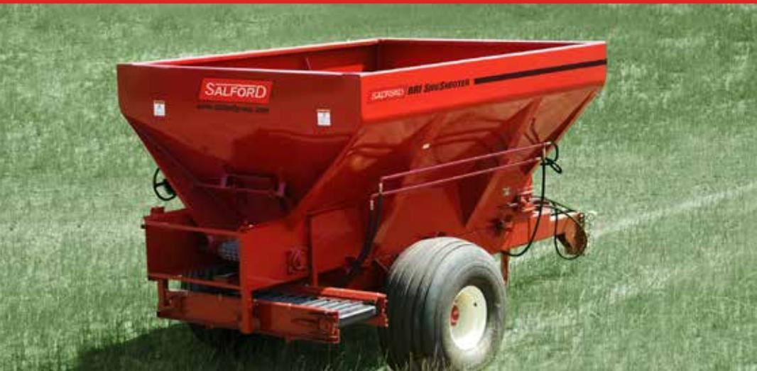
**Idéal pour :** Distribution latérale de matériaux de litière (c.-à-d. sable, copeaux de bois, etc.), granulés de poisson ou matériaux similaires
