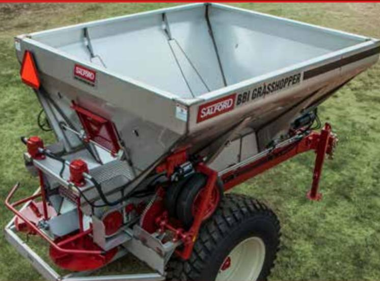
**Idéal pour :** Distribution d'engrais granulaires ou de chaux / Capacité moyenne / Dégagement élevé / Applicateur classique à un seul essieu pour gazon en plaques, pâturages et cultures en rangs / Conçu avec un dégagement élevé pour chevaucher les rangs
