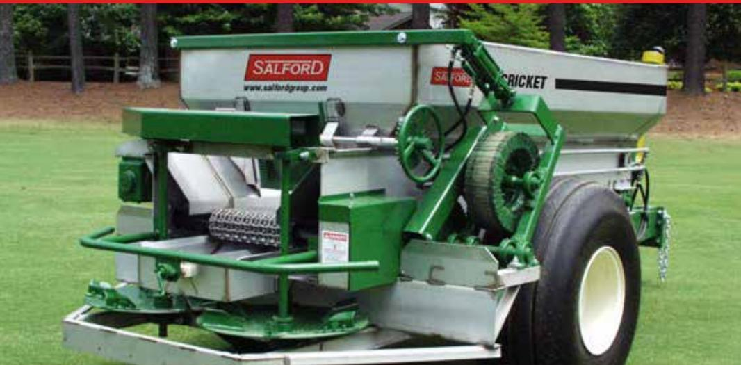
**Idéal pour :** Engrais ou la chaux / Terrains de golf, gazon en plaques / parcelles alimentaires et petites fermes / Peut être tiré avec un tracteur à faible puissance / Convoyeur à roues motrices au sol / Prise de force ou patineurs à entraînement hydraulique
