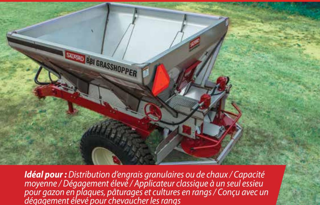
**Idéal pour :** Distribution d'engrais granulaires ou de chaux / Capacité moyenne / Dégagement élevé / Applicateur classique à un seul essieu pour gazon en plaques, pâturages et cultures en rangs / Conçu avec un dégagement élevé pour chevaucher les rangs
